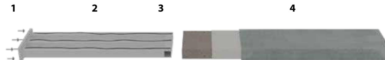
**1. Anclaje:** Depende del tipo de pared. Solo disponible para muros de hormigón y vigas metálicas.
