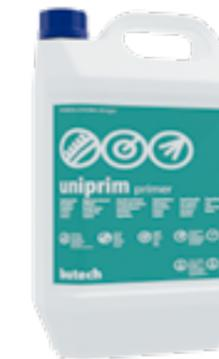
Permite de forma fácil y eficaz la colocación de baldosas cerámicas con adhesivos base cemento tipo C2 sobre soportes de yeso, anhidrita o escayola. Reduce la absorción de soportes excesivamente absorbentes evitando la deshidratación rápida del adhesivo cementoso empleado, facilitando así su correcto fraguado. Imprimación previa a la aplicación de autonivelantes sobre soportes absorbentes, evitando la aparición de burbujas o fisuras por un secado rápido.
