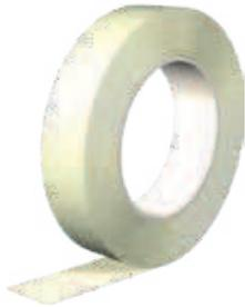
**Cinta de carrocero de alta calidad**, con un grosor de 110 micras, fabricada con papel crepé recubierto de aceite de silicón por un lado y de adhesivo acrílico a base de agua por el otro.
