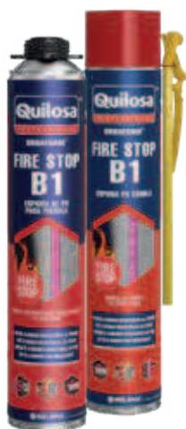
Espuma de poliuretano B1 para protección pasiva contra incendios. Diseñada para sellar, aislar, rellenar juntas, grietas, aberturas de ventanas y puertas, juntas entre tabiques, muros cortafuegos, donde se requiera compartimentación contra el fuego. Aporta una estabilidad y aislamiento al fuego hasta 4 horas según la norma UNE EN 1366-4/13501-2.
