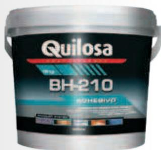
**Adhesivo híbrido de un componente que cura con la humedad atmosférica. Todo tipo de pavimentos de madera: tamaño/origen.** Especialmente desarrollado para la instalación de parquets especiales, parquet laminado, planchas de madera de revestimiento, suelos de parquet tratados con resinas, parquet barnizado, parquet de contrachapado y parquet de maderas exóticas (teca, bambú, etc.). Tiene una excelente adherencia a la mayoría de los sustratos, incluidos madera, hormigón y piedra.
