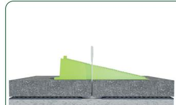
La pieza de nivelación XXL ofrece una altura suficiente para alcanzar espesores más altos, abastece hasta 25 mm de espesor de baldosa.
