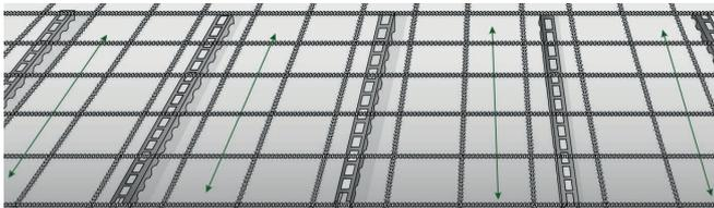
Se recomienda la colocación en paralelo a la armadura horizontal.
