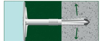
Taco ISO Pro y Eco con clavo de nylon para la colocación de materiales aislantes
