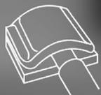
El plano de contacto de la conexión del cableado se realiza como "puente de arco" para una fijación más fiable del cable.
