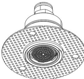
Il sistema ad incasso del microsoffione, rasabile e verniciabile, viene installato dal basso e nascosto nel cartongesso durante le fasi di finitura del contro soffitto.
