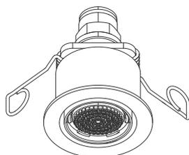
Nella versione FRAME non sono richieste speciali opere murarie. L'installazione avviene tramite la realizzazione di un foro da 37 mm nel cartongesso e l'inserimento dal basso del microsoffione. Il bloccaggio è garantito da un pratico sistema a molla.
